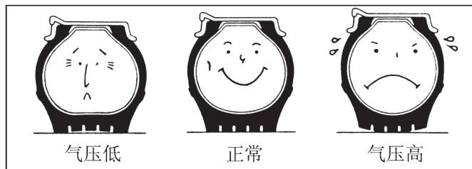
检查轮胎的情况，气压过低会降低轮胎的寿命，增加燃油的消耗。左右轮胎气压不同或轮胎损伤将引起转向力不同。
